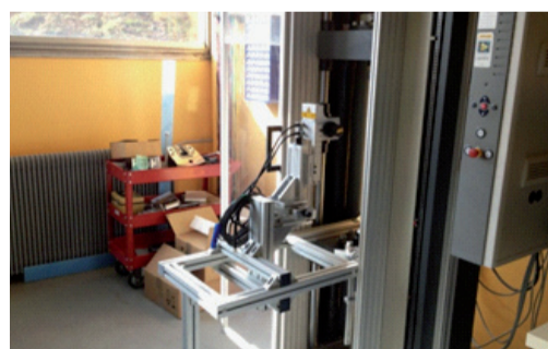
Montage de l'interferomètre de Speckle sur la machine de traction Zwick/Roell
