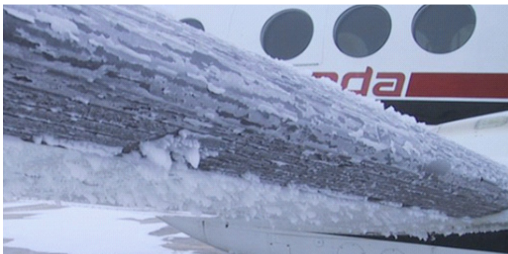
Figure 1. Phénomène de givrage sur le bord d'attaque d'une aile d'avion.
