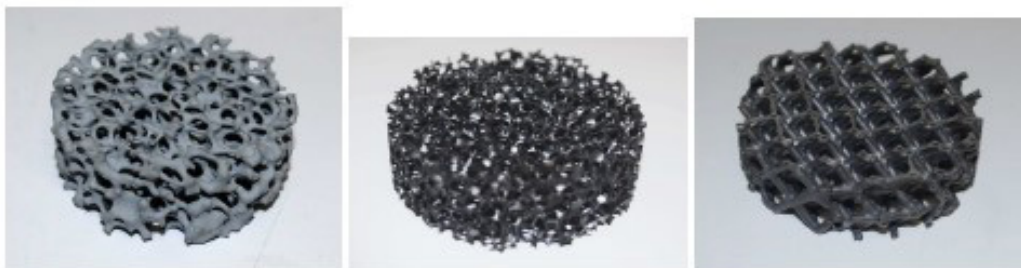
Exemples de mousses structurées et stochastiques étudiées (SiC et SiSiC)
