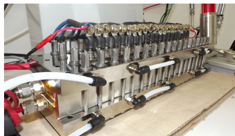
Cellule segmentée et instrumentée en fonctionnement
