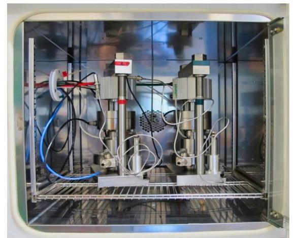
Œdomètre à température contrôlée (-20 à +60°C)
