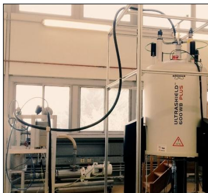
Photo de la boucle ROMANE traversant un spectromètre RMN
